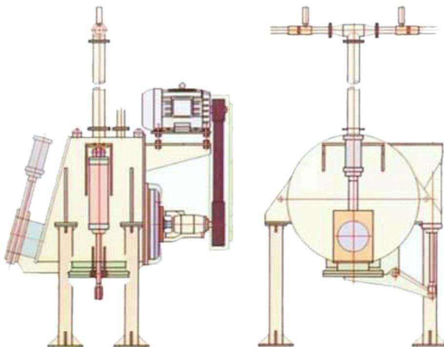
O sistema para limpeza para Pulper através do descontaminador foi concebido para eliminar todas as impurezas (contaminantes), leves e pesadas, presentes hoje nos papéis a serem recuperadas (aparadas).
